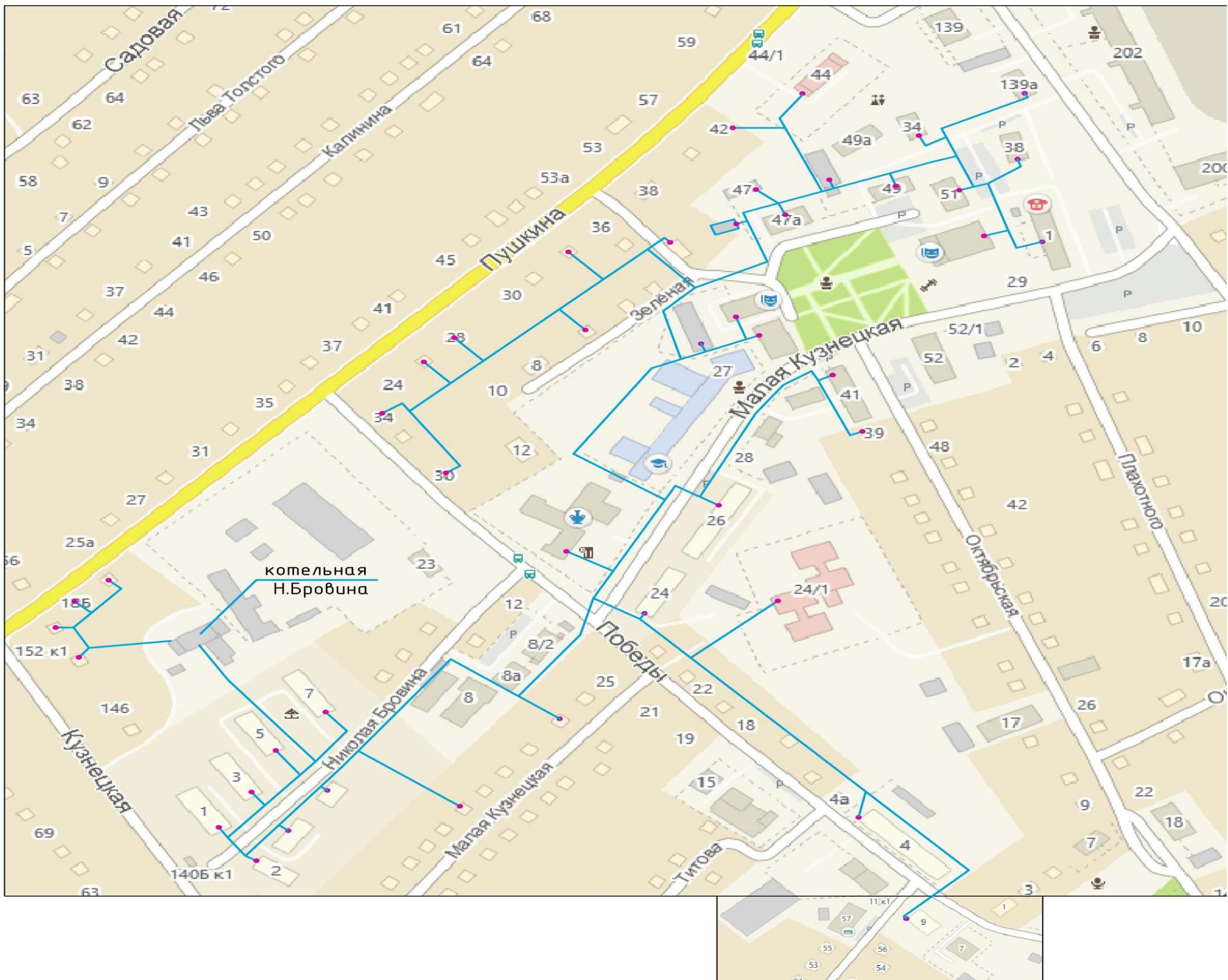
Рисунок 1.1 – Зона действия и схема тепловых сетей котельной Н.Бровина
