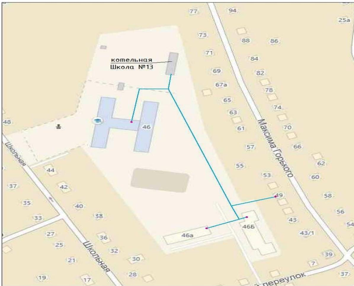
Рисунок 1.4 – Зона действия и схема тепловых сетей котельной Школы №13
